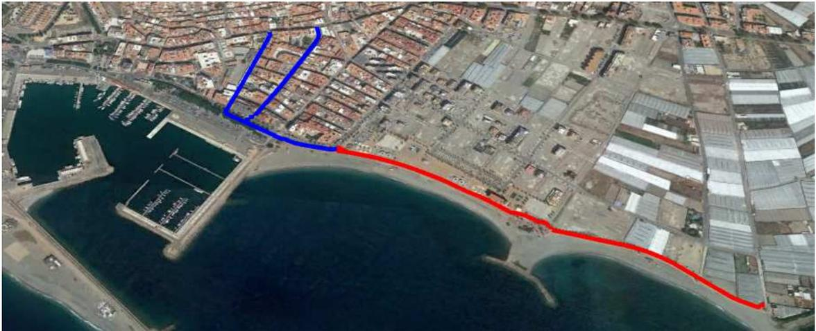
La vía ciclable propuesta consiste en dotar a lo largo de las calles Tarrasa y Paseo Navegantes de una vía de coexistencia mediante el uso de marcas viales en calzada que indiquen la unidireccionalidad compartida para ambos modos de transporte. La sección tipo sugerida podría consistir en:
