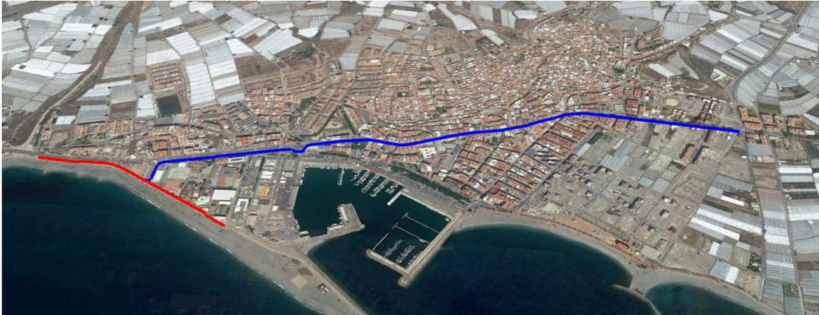
El carril bici propuesto consistiría en dotar a lo largo de todas las vías mencionadas de un carril bici bidireccional segregado del carril (o carriles) destinados a la circulación motorizada mediante el uso de un carril por sentido segregado con el uso de marcas viales en la calzada.
